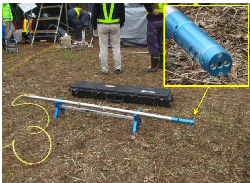
写真3 3Dレーザースキャニング装置
